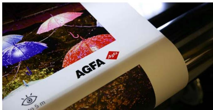
Il est notamment possible d'imprimer sur des supports tels que le vinyle coulé ou calandré, le film vinyle électrostatique, les films transparents en rouleau, la toile, la maille (avec et sans revêtement), les tissus, le papier, les supports rétroéclairés, etc.
