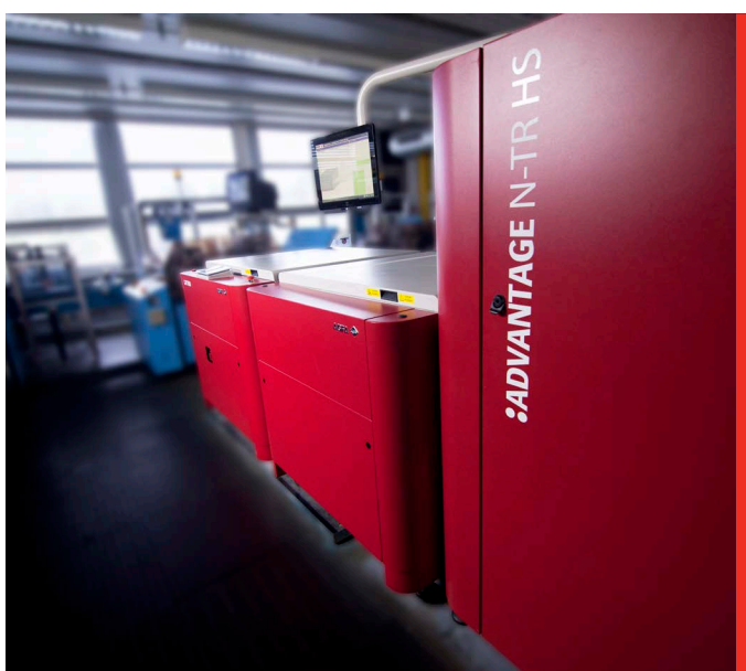
Sistema completo de alto volumen de producción de planchas Advantage N-TR HS con COU Attiro VHS en línea.
