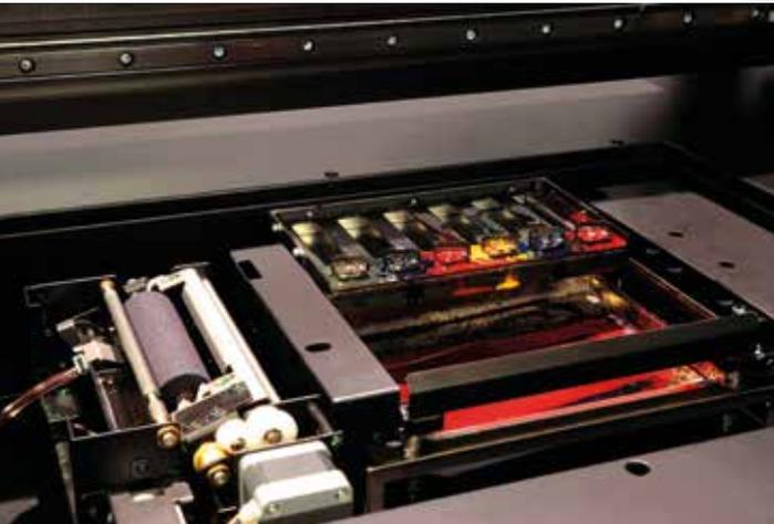
Nettoyage automatique des têtes d'impression
