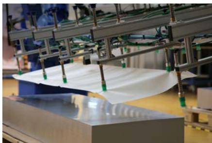
Il braccio ruota successivamente di 180° per prelevare la velina tramite gli aspiratori sul lato posteriore.
