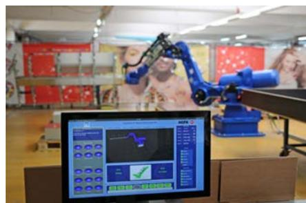
La GUI interattiva permette di seguire i movimenti del robot, invia inoltre messaggi di attenzione quando è il momento di sostituire il pallet o di svuotare il contenitore delle veline.
