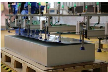
Le lastre di stampa sono impilate sul pallet con l'emulsione sul lato inferiore. I sensori rilevano l'altezza della pila e la posizione. Il lato frontale del braccio preleva la lastra tramite le apposite ventose aspiranti.
