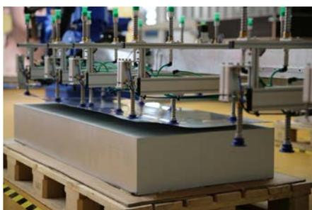
As chapas de impressão são empilhadas em um pallet. Sensores detectam a altura e a posição da pilha. O lado frontal do braço coletor captura as chapas.
