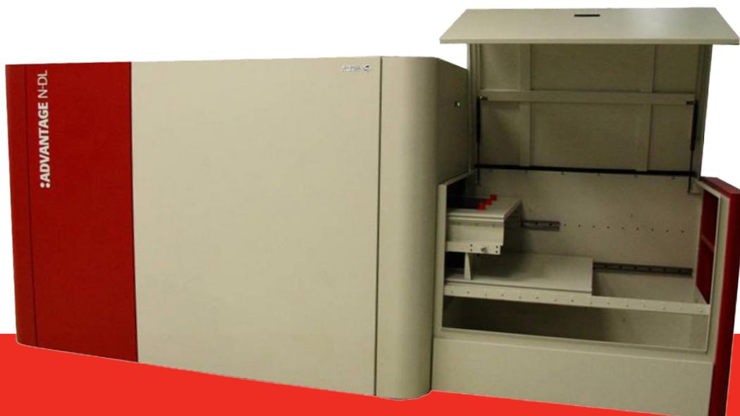
Die Advantage N-DL kann die kontinuierliche Belichtung für bis zu 1500 Platten bei einer von Auflösung und Plattengröße abhängigen Durchsatzgeschwindigkeit von bis zu 300 pph ausführen.
