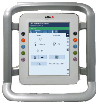
Joonis 4: Röntgenitoru statiivi juhtpaneel toruploki ekraaniga (juhtelemendid röntgenitoru asendi ja röntgeniülesvõtete parameetrite jaoks)
