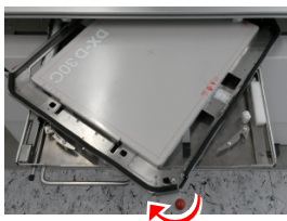
Рисунок 111. Пример: чтобы изменить книжную ориентацию на альбомную, поверните держатель по часовой стрелке
