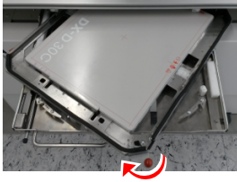
Figura 75: Ejemplo: hágalo girar en sentido horario para cambiar de la posición vertical a la posición horizontal
