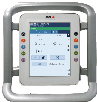
Figura 4: Panel de control del soporte del tubo de rayos X con pantalla en el cabezal del tubo (controles para la posición del tubo de rayos X y para los parámetros de exposición de los rayos X)
