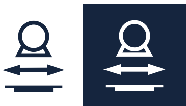
Figura 33: Seguimiento de posición de la mesa radiográfica activado y desactivado
