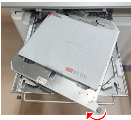
Figura 15: Ad esempio: ruotare in senso orario per passare dalla posizione verticale a quella orizzontale.
