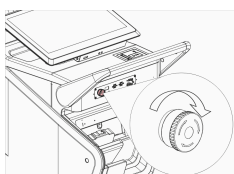
ábra 7: A vészleállító gomb kioldása
