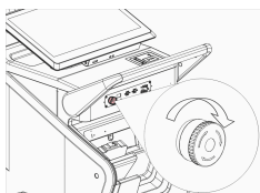
Рисунок 7. Разблокировка кнопки аварийного останова
