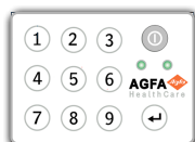
Figura 10: Teclado opcional para substituir a tecla para ligar e desligar a unidade.
