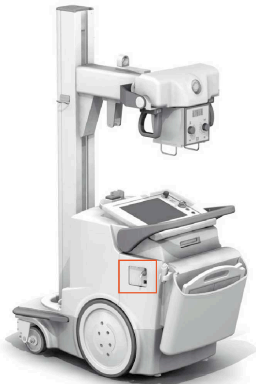
Figuur 14: Indicatie van de netwerkkabel
