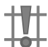
Figura 59: Indicación en la pantalla del cabezal del tubo para el modo de colimación semiautomático
