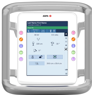
Slika 4: Upravljačka ploča jedinice glave rendgenske cijevi sa zaslonom glave cijevi (kontrolne položaj rendgenske cijevi i parametre rendgenske ekspozicije)
