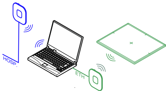
Рисунок 1. Точка доступа, подключенная к рабочей станции посредством сетевого кабеля
