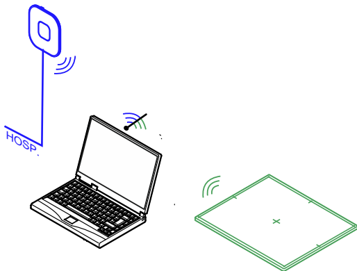
ábra 1: A Windows Wi-Fi beállításai lehetővé teszik a detektor és a kórházi hálózat közötti váltást
