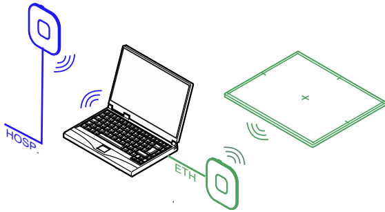
Kuva 1. Työasemaan verkkokaapelilla yhdistetty tukiasema
