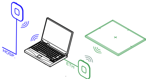
Figur 1. Åtkomstpunkt ansluten till arbetsstation via nätverkskabel
