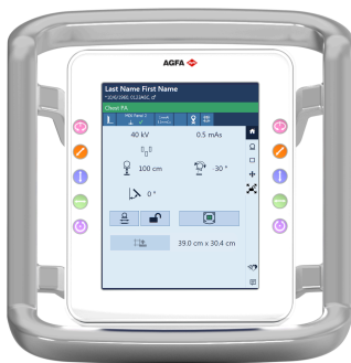
Figuur 4: Bedieningspaneel van de röntgenbuiscopeenheid met buiskopdisplay (bedieningselementen voor röntgenbuispositie en röntgenbelichtingsparameters)
