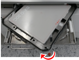
Figura 15: Ejemplo: hágalo girar en sentido horario para cambiar de la posición vertical a la posición horizontal
