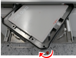
Kuva 15. Esimerkki: suunnan muuttaminen pystysuunnasta vaakasuuntaan myötäpäivään kiertämällä
