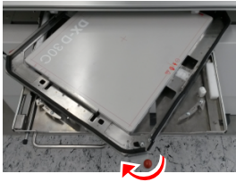
Figura 15: Exemplo: rode para a direita para mudar da posição vertical (retrato) para a posição horizontal (paisagem)
