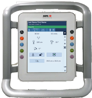
Slika 4: Upravljačka ploča stativa rendgenske cijevi sa zaslonom glave rendgenske cijevi (kontrola za položaj rendgenske cijevi i parametre rendgenske ekspozicije)
