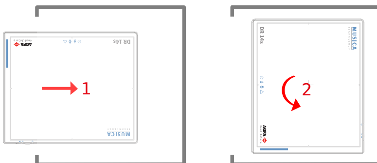
Slika 77: Okomiti smjer (portret) u rendgenskom zidnom stativu, punjenje s lijeve strane
