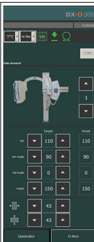
Figuur 5: Bedienungselementen voor de auto- matische positionering van het röntgensys- teem
