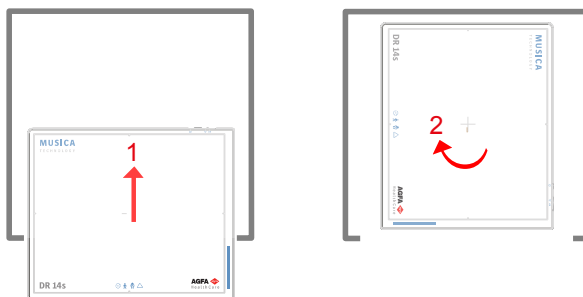
Abbildung 13: Ausrichtung im Röntgenbild im Querformat
