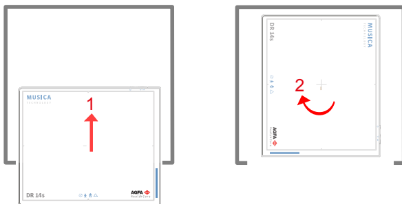
Εικόνα 13: Οριζόντιος προσανατολισμός στην ακτινογραφική έδρα
