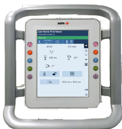
Afbeelding 4: Bedieningspaneel van de röntgenbuiskopeenheid met buiskopdisplay (bedieningselementen voor röntgenbuispositie en röntgenbelichtingsparameters)
