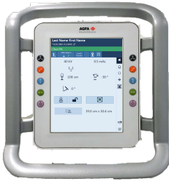
Figur 4: Röntgenrörstativets kontrollpanel med rörhuvudskärm (kontroller för röntgenrörposition och röntgenexponeringsparametrar)
