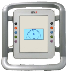
Figur 5: Röntgenrörstativets kontrollpanel med visning av röntgenrörvinkel
