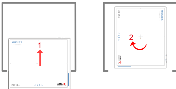
Figure 76 : Orientation Paysage sur la table radiographique
