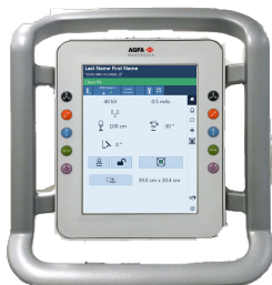
Figure 4 : Panneau de commandes du support du tube à rayons X avec affichage de la tête du tube (commandes de la position du tube à rayons X et des paramètres d'exposition radiographique)
