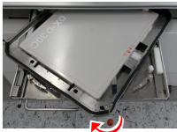
Kuva 69: Esimerkki: suunnan muuttaminen pystysuunnasta vaakasuuntaan myötäpäivään kiertämällä
