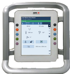
Рисунок 4: Панель управления стойкой рентгеновской трубки с дисплеем головки рентгеновской трубки (контролирует положение рентгеновской трубки и параметры рентгеновской экспозиции)
