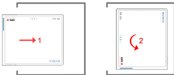
77. Ábra: Álló irányultság a radiográfiai fali állványban, bal oldali betöltésnél
