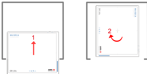
Rysunek 76: Orientacja pozioma w stole radiograficznym
