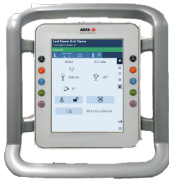
Εικόνα 4: Πίνακας ελέγχου της βάσης λυχνίας ακτίνων X με οθόνη κεφαλής σωλήνα (στοιχεία ελέγχου για τη θέση της λυχνίας ακτίνων X και τις παραμέτρους έκθεσης σε ακτίνες X).
