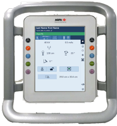
Figur 4: Kontrollpanel for stativet til røntgenrøret med slangehodeskjermer (kontroller for røntgenrørposisjon og parametre for røntgeneksponering)
