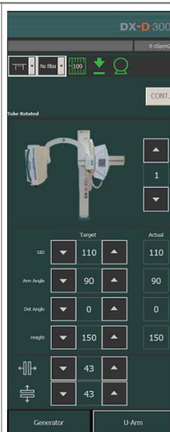
**Abbildung 5: Bedienelemente für die automatische Positionierung des Röntgensystems**
