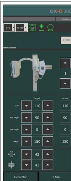
**Figura 5: Comandi per il posizionamento automatico del sistema a raggi X**
