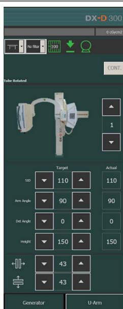
**Рисунок 5: Органы управления функцией автоматического позиционирования рентгеновской системы**
