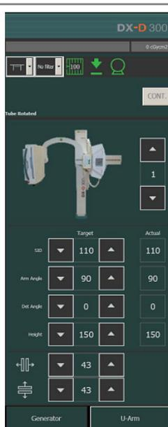
**Рисунок 5: Органы управления функцией автоматического позиционирования рентгеновской системы**
