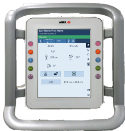
Figure 4 : Panneau de commandes de l'unité de la tête de tube à rayons X avec affichage de la tête du tube (commandes de la position du tube à rayons X et des paramètres d'exposition radiographique)
