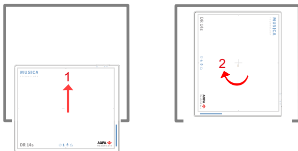
Obrázek 73: Orientace na šířku v radiografickém stole
