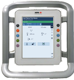
Kuva 4: Röntgenputken telineen ohjauspaneeli, joka sisältää putken näytön (käytetään röntgenputken asennon ja röntgenvalotusten parametrien hallintaan)
