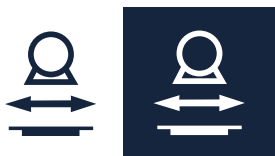
Figura 34: Seguimiento de posición de la mesa radiográfica activado y desactivado
