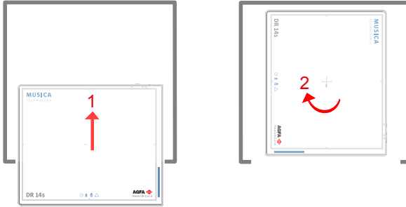
Figura 73: Orientación horizontal en la mesa radiográfica
