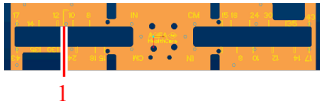
Figura 68: Bucky del wall stand con rivelatore di grande formato posizionato sopra il bucky
