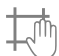
Figura 58: Indicazione sul visualizzatore della testa del tubo per la modalità di collimazione manuale
