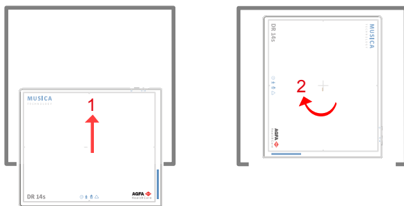
72. Ábra: Fekvő irányultság a radiográfiai asztalban
