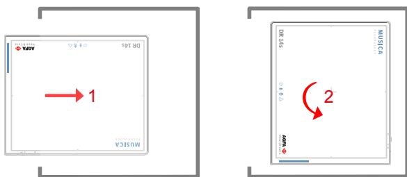
73. Ábra: Álló irányultság a radiográfiai fali állványban, bal oldali betöltésnél
