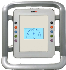
Abbildung 5: Bedienelemente des Röntgenröhrenstativs mit Anzeige des Röntgenröhrenwinkels
