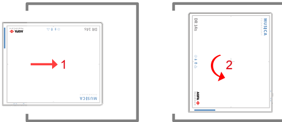
Abbildung 73: Ausrichtung im Hochformat im Röntgen-Wandstativ bei linksseitigem Einlegen
