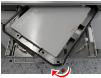
Abbildung 65: Beispiel: Drehen Sie im Uhrzeigersinn, um von der Hochformat- zur Querformatposition zu wechseln
