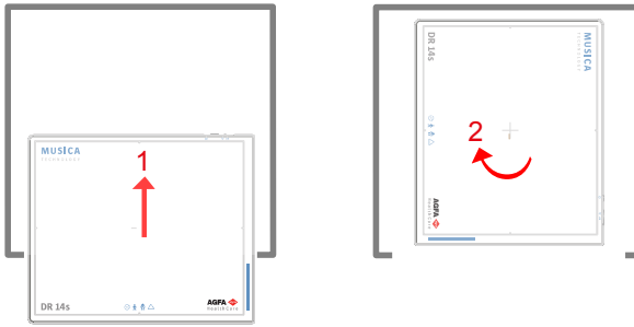
Abbildung 72: Ausrichtung im Röntgenisch im Querformat
