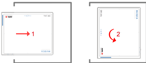
Figur 73: Stående orientering i röntgenväggstativet vid laddning på vänster sida
