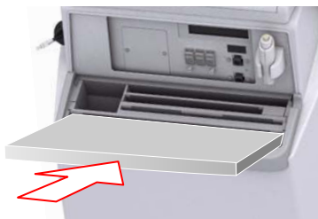
Figura 11: O Detector DR é inclinado para a frente na ranhura dianteira do depósito
