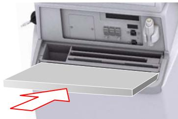
**Abbildung 11: DR-Detektor im vorderen Fach des Aufbewahrungsbehälters nach vorne gekippt**
